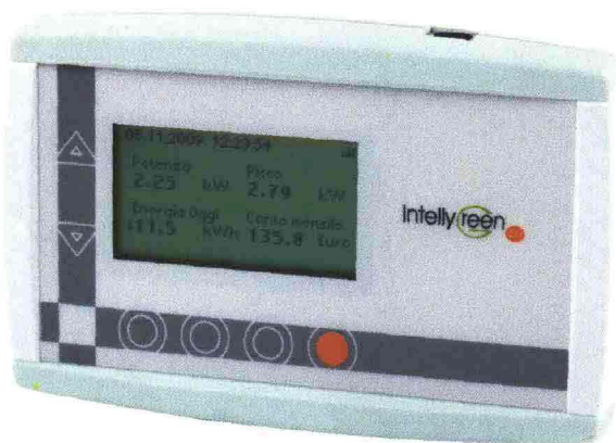
Il sensore ottico del sistema «Intellygreen PV» rileva gli impulsi luminosi emessi dai contatori di corrente.
