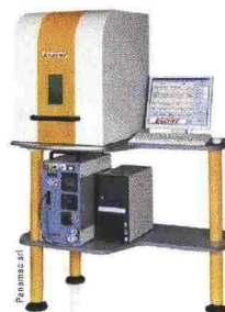
«Scribing» e tranciatura: la macchina di taglio laser di Panamac è in grado di segare le celle nelle forme e dimensioni desiderate, per realizzare moduli più piccoli.
