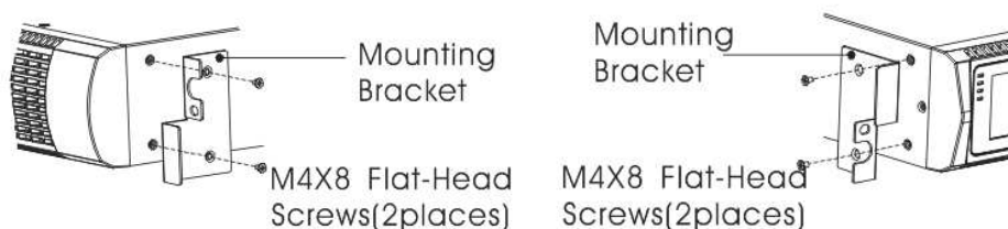
FIG.5 Installazione delle staffe di montaggio
