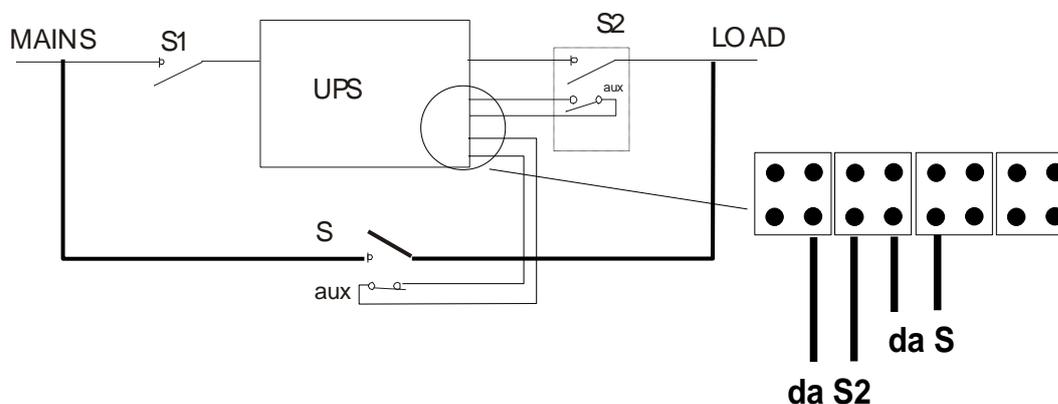
S2 sezionatore di uscita aggiunto, S sezionatore aggiunto di by-pass di manutenzione esterno.
