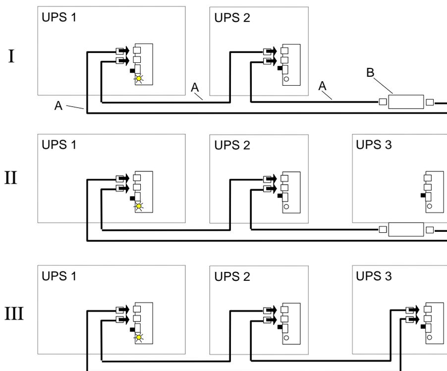
A) UPS ups parallel cable tipo RJ45
