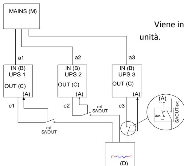
Viene indicato un esempio di collegamento in parallelo di tre unità.
