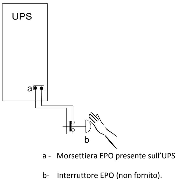
Sull'UPS dovrà essere rimosso il ponticello presente sui morsetti EPO, in sostituzione del ponticello devono essere collegati i fili provenienti dal contatto del pulsante.
